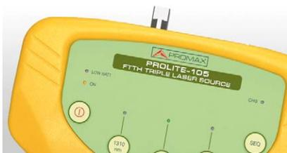
Излучает свет на трех длинах волн, для передачи данных по оптическому волокну в сетях FTTH: 1310, 1490 и 1550 нм. Позволяет легко выбрать желаемую длину волны с помощью клавиш прямого доступа, чтобы генерировать модулированный сигнал или активировать автоматический режим работы. Эти источники света могут быть модулированы для измерения затухания волокна для трех длин волн в сочетании с измерителем мощности. Прибор требуется для сертификации телекоммуникационных инфраструктур.
