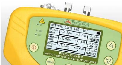
**PROLITE-67** - прибор предназначенный для одновременного измерения трех длин волн, используемых в оптическом волокне. Позволяет сертифицировать любую установку и проводить измерения, не прерывая обслуживание. Имеет визуальный локатор неисправностей, (непрерывный или прерывистый) и позволяет пользователю обнаруживать порезы или разрывы, идентифицировать волокна и т. д.
